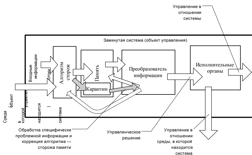
Схема 3. Алгоритм управления с защитой от целенаправленных помех извне
