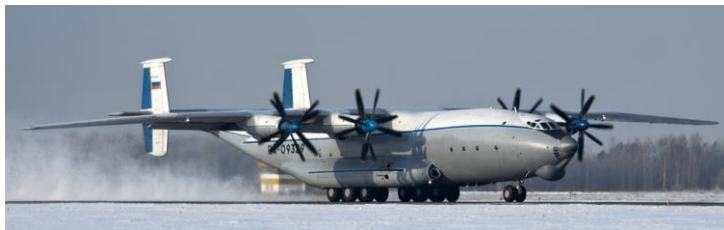
Рис. 2-1. Ан-22 — тяжелый транспортный самолёт СССР. Первый полёт в 1965 г. Грузоподъёмность 60 т. Максимальная взлётная масса 225 т. Практическая дальность полёта 5 225 км. Экипаж 5-7 человек; количество сопровождающих груз — до 28 человек. Снят с эксплуатации в военно-транспортной авиации России в 2024 г.
