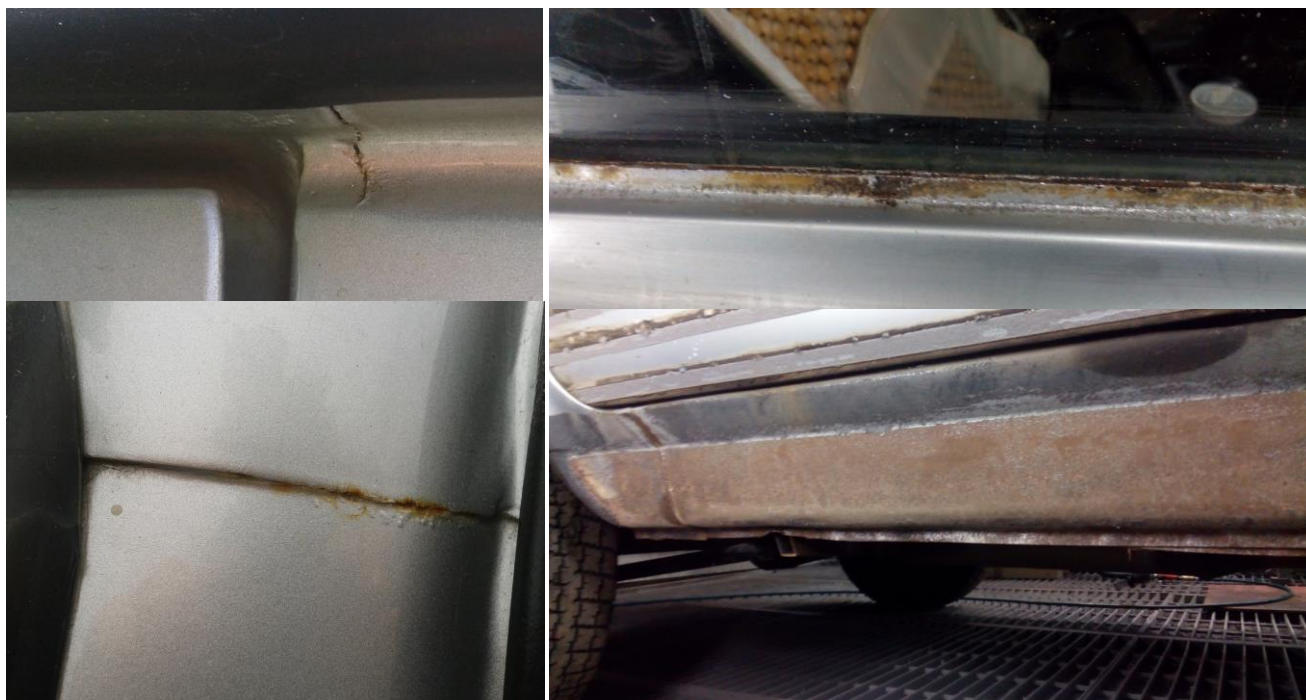
Рис. 7.2-6. VA3-2131 — коррозия кузова.
