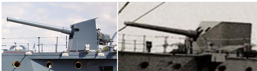
Рис. 6-4. Щиты на орудиях крейсера «Аврора»: слева — в наши дни; справа в период 1907 — 1917 гг.
